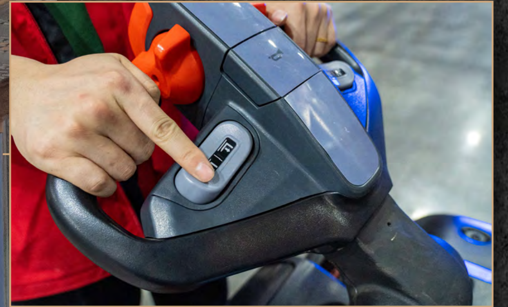
Hassasiyet için Oransal Kaldırma Fonksiyonu
