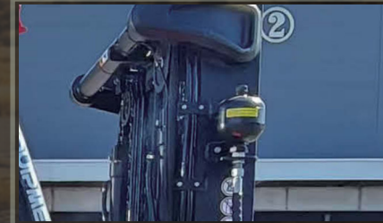
İsteğe Bağlı Mast Sönümlleme Akümülatörü
