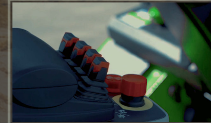
Tam oransal solenoid valf ile fingertip kontrol
